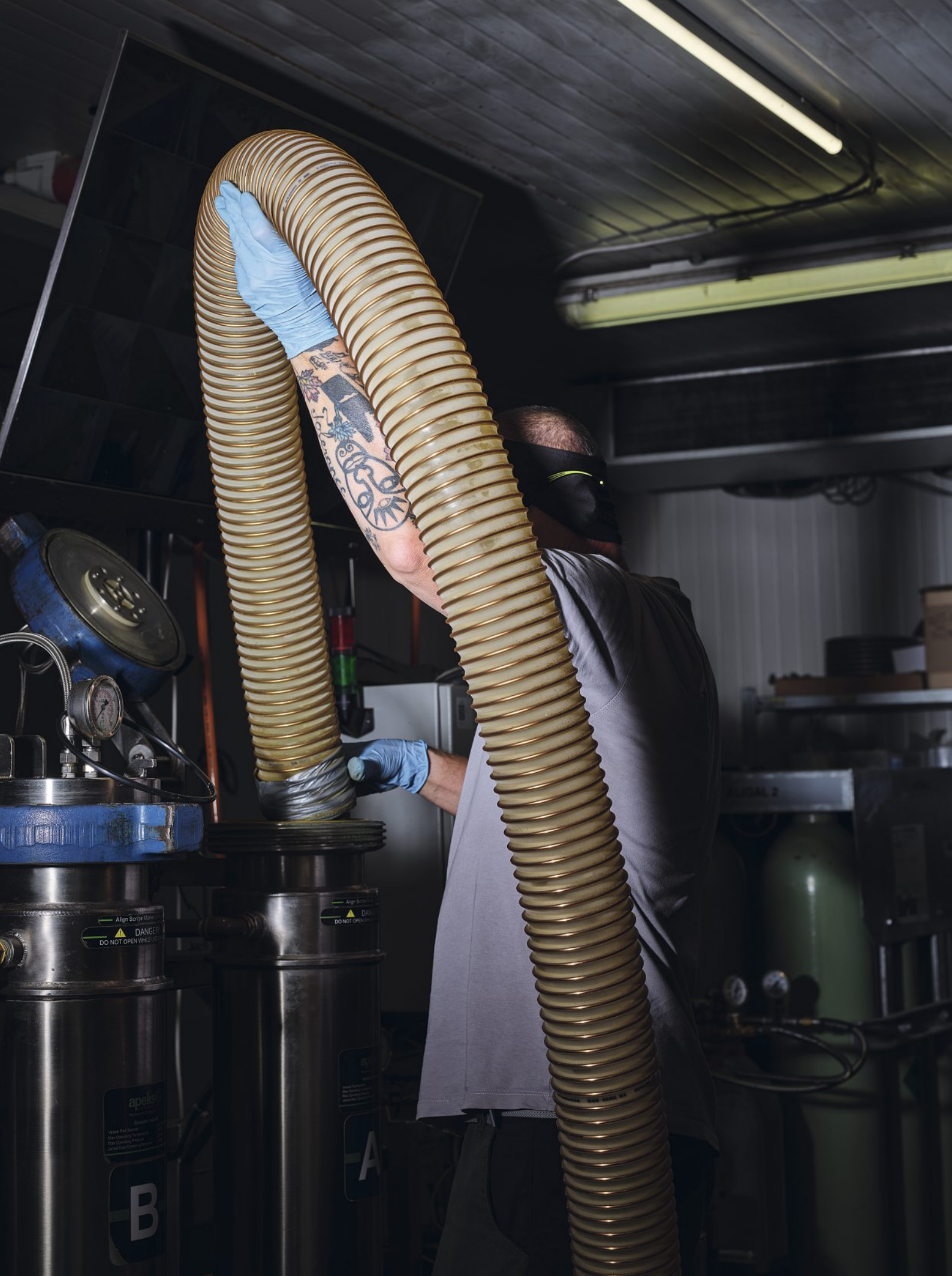
Nach dem Extraktionsprozess wird in der CO 2 -Extraktionsmaschine das restliche Pflanzenmaterial entfernt.
